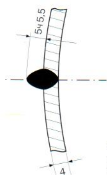
Рис. 3. Схема продольного шва обечайки
